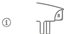
Le guide sono contrassegnate con una piccola L (sinistra) e da una R (destra) nella parte posteriore, per indicare in quale lato vanno inserite. Assicurati di inserirle nei lati corretti.
